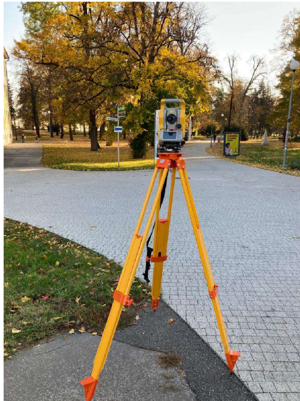
Obr. 4 Totálna stanica Trimble M3-DR2" (zdroj: autor)
