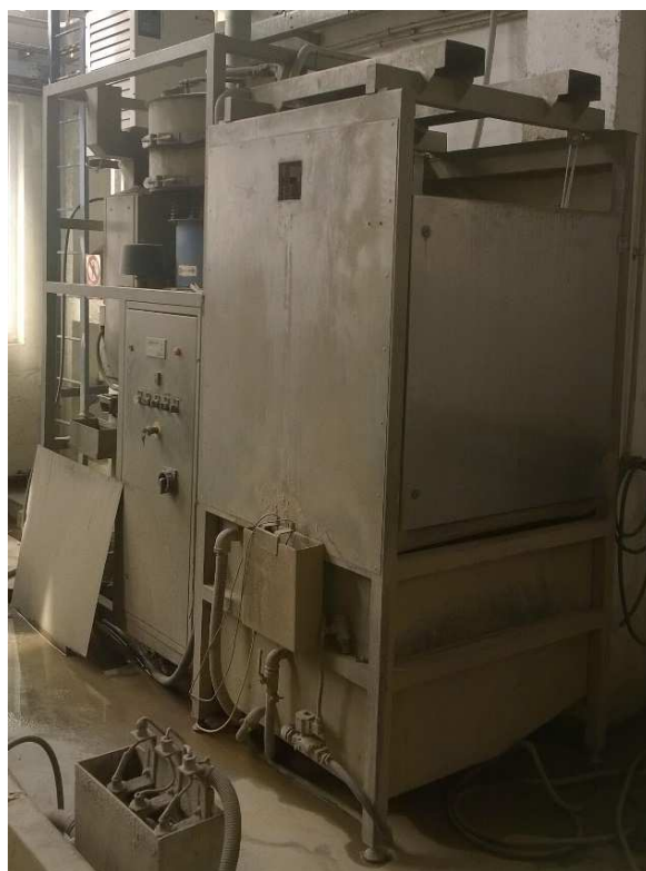
Obr 3.6 Stroj na recyklaci abraziva
