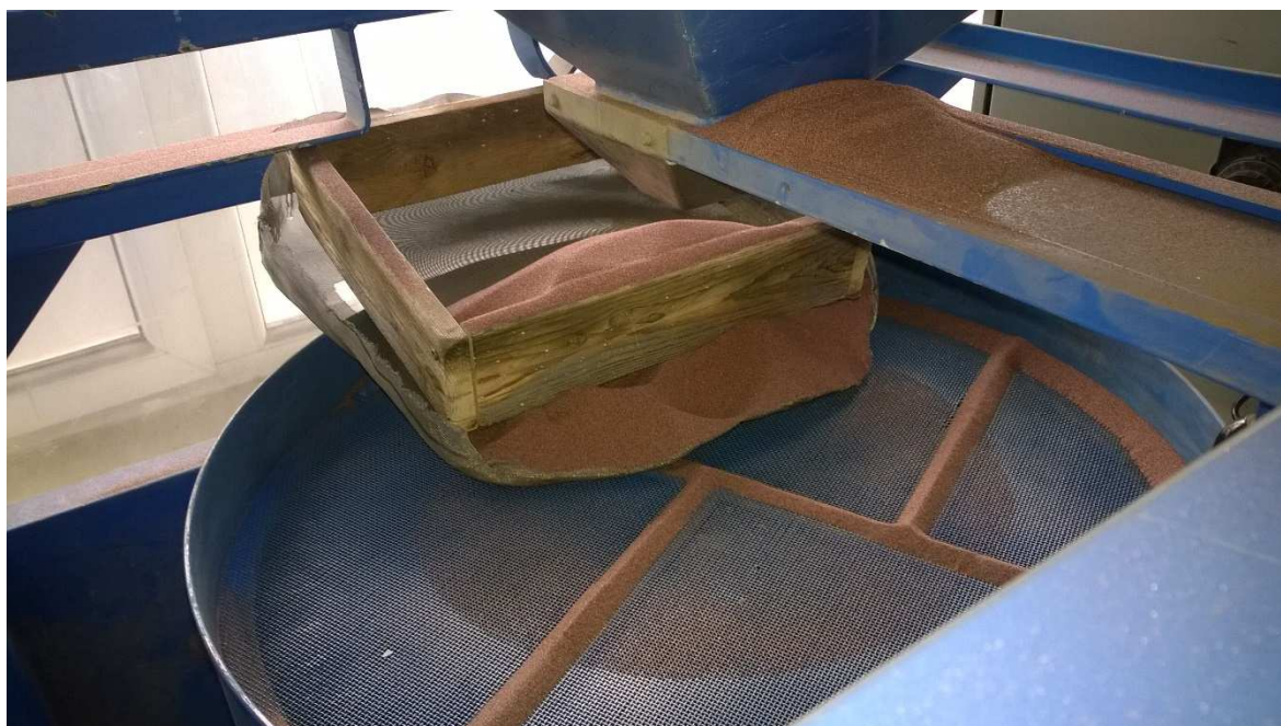
Obr. 3.7 Abrazivo Garnet MASH 80 na sítech
