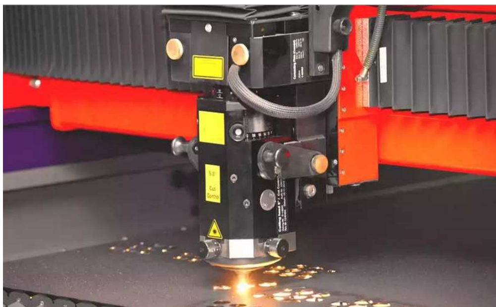
Obr. 2.2 Laserová hlava při provozu [20]
