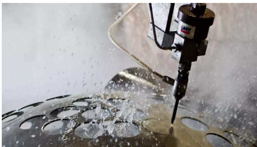
Obr. 2.3 Řezací hlava při obrábění [21]
