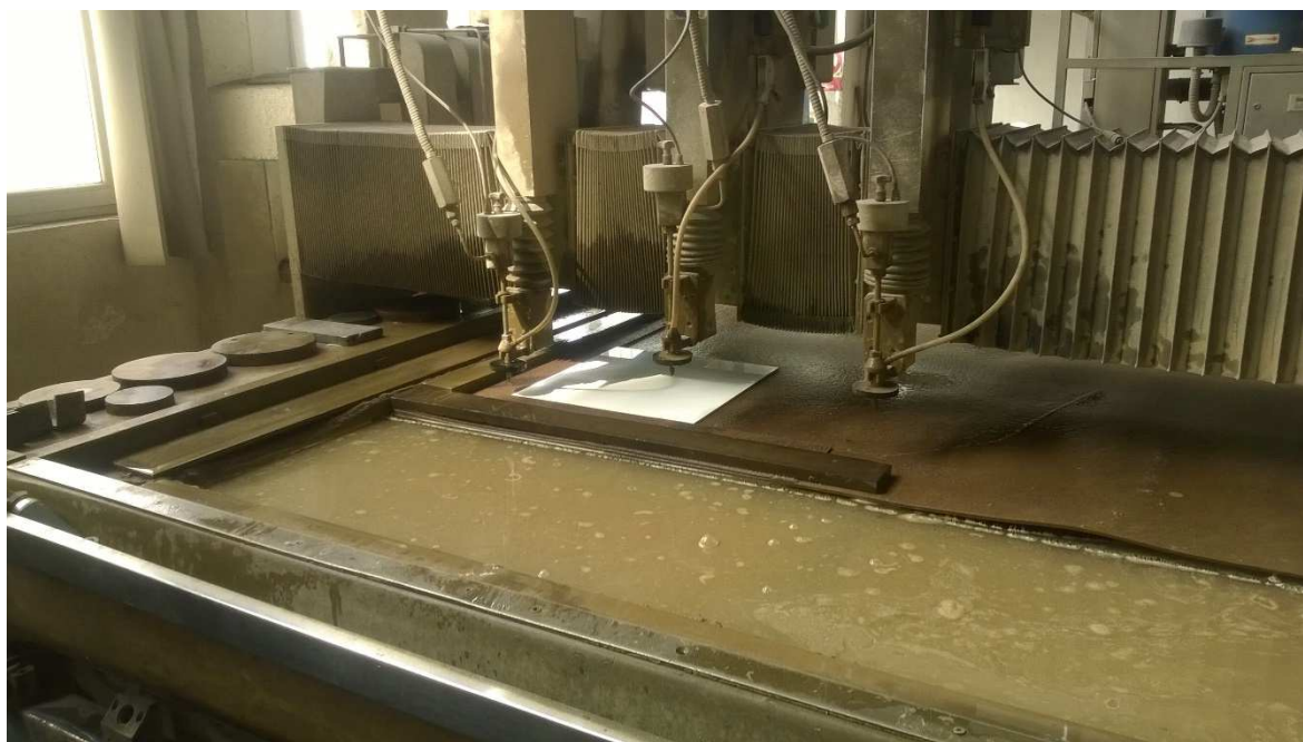
Obr 3.5 Řezací trysky stroje NC 4030T
