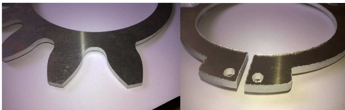
Obr 4.1 Porovnání otřepů po použití jednotlivých metod
