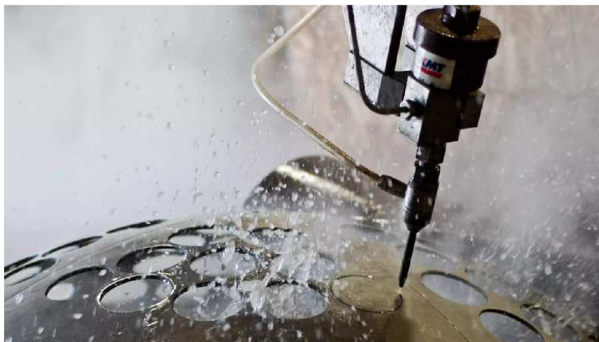
Obr. 2.3 Řezací hlava při obrábění [21]
