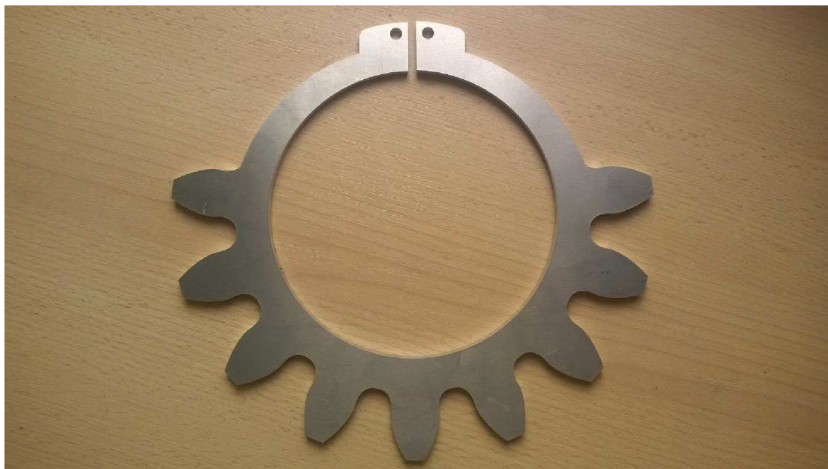
Obr 3.1 Obrobené základní těleso nástěnných hodin
