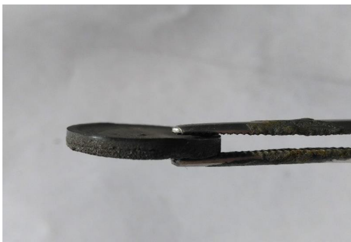
Obrázek 14: Strukturní vzorec polystyrenu (vlevo), vzorek připravený na bázi polystyrenového pojiva - před vyžiháním (vpravo)
