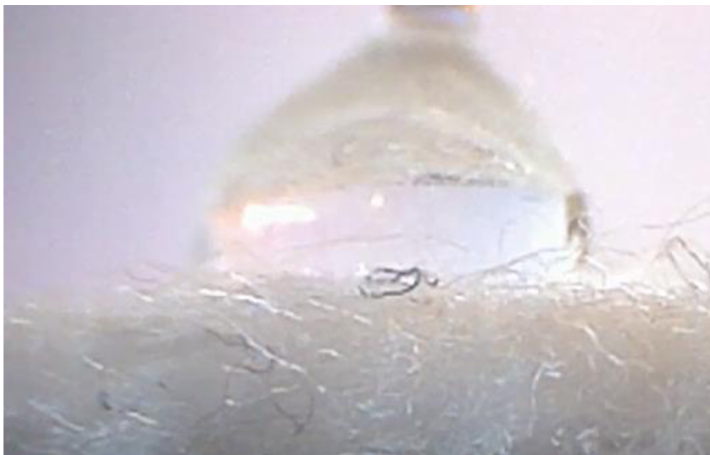
Obrázek 11: Vytvořená kapka vody na materiálu polypropylen 500 g/m 2 .
