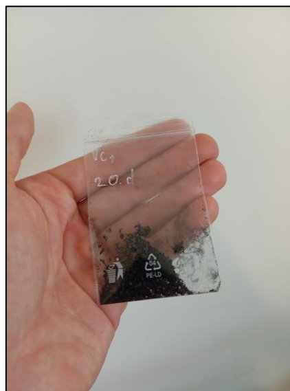
Obr. 15 - Třísky sesbírané po vyvrtání 20-té díry při rezné rychlosti v_{c1}
