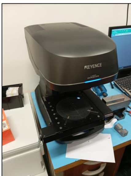
Obr. 14 – Konfokální mikroskop Keyence VK-X 1000
