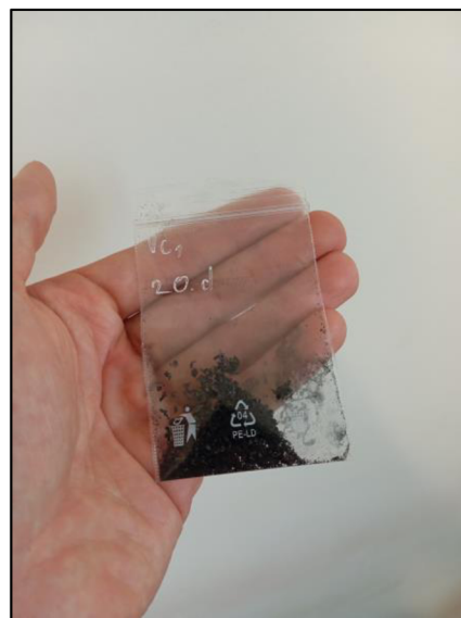
Obr. 15 - Třísky sesbírání po vyvrtání 20-té díry při řezné rychlosti v_{c1}
