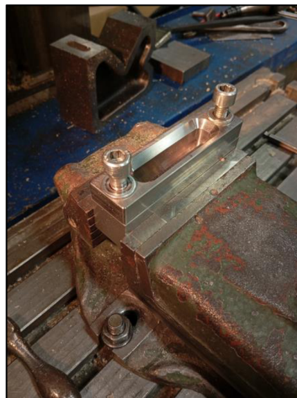
Obr. 13 – Upínací přípravek ve svěráku
