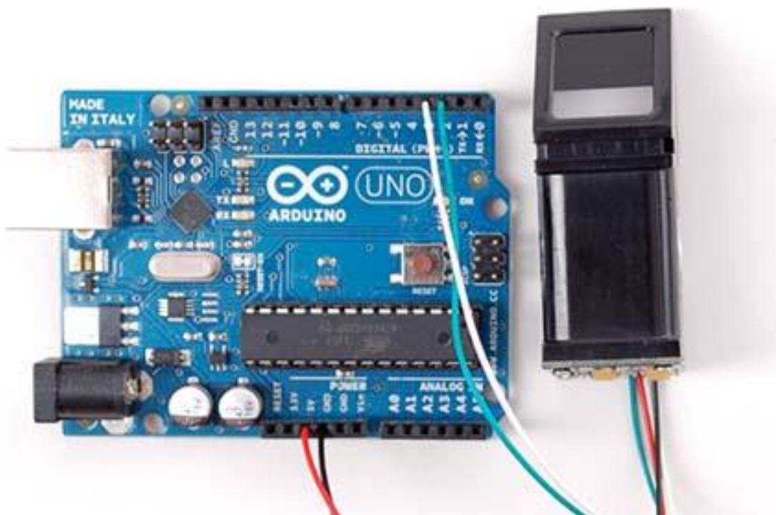
Obrázek 9 : Zapojení čtečky otisku prstu
