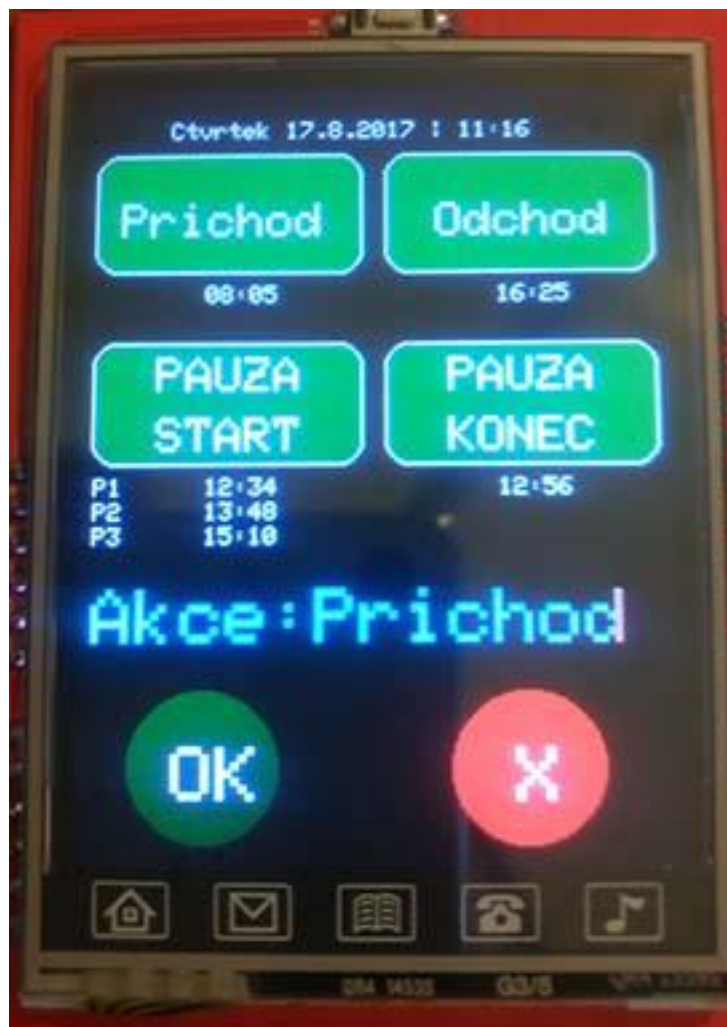
Obrázek 10 : Uživatelské rozhraní na dotykovém displeji Arduina
