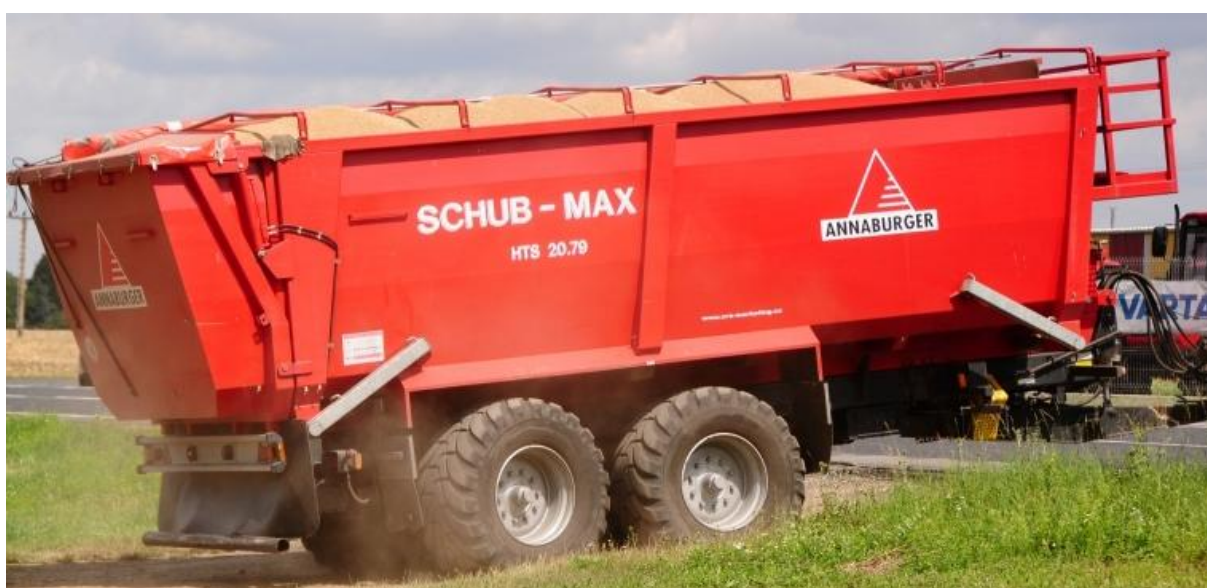
Obr. 20 - Vyhřnovací nástavba s traktorovým nosičem nástaveb [18]
