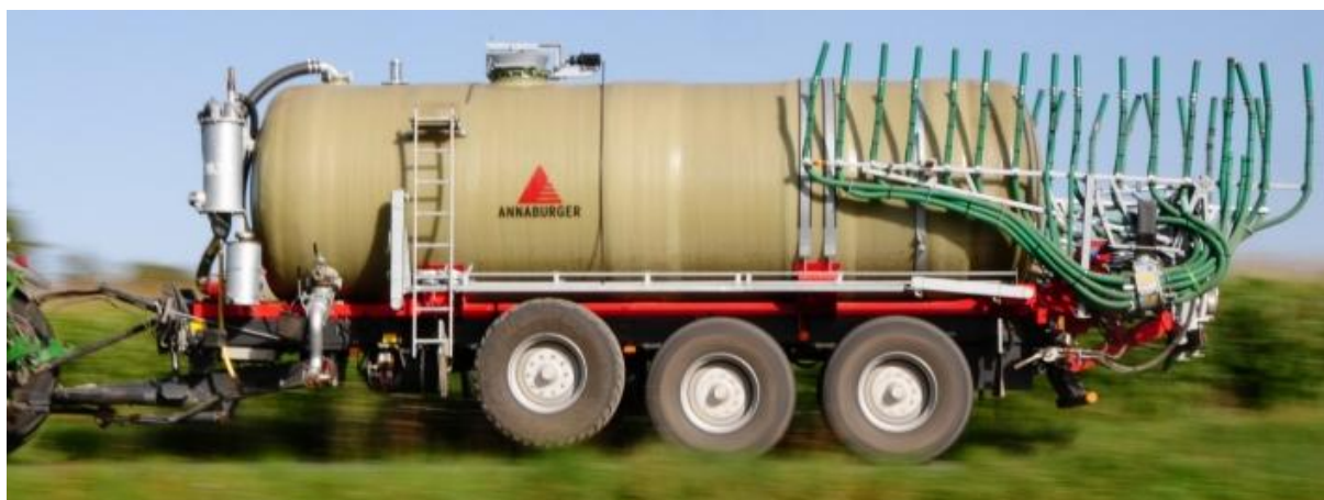
Obr. 23 - Cisternová návstava s traktorovým nosičem návstaveb [18]
