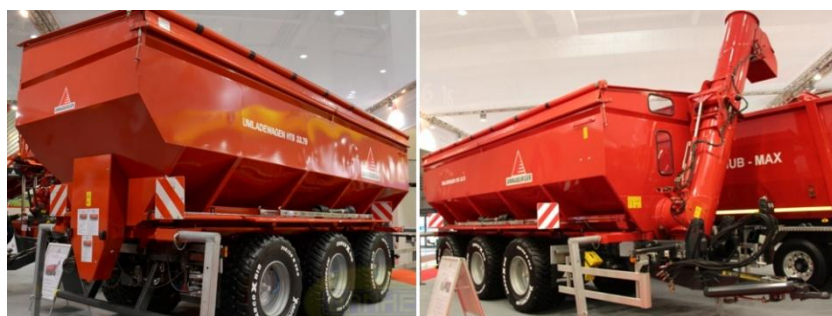
Obr. 24 - Překládací návstava s traktorovým nosičem návstaveb [18]
