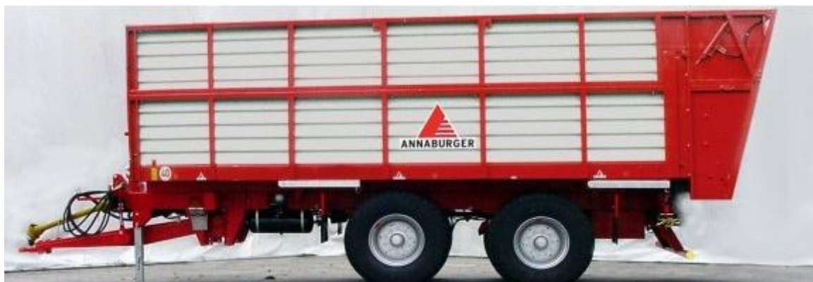
Obr. 21 - Velkoobjemová nástavba s traktorovým nosičem nástaveb [18]
