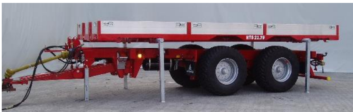
Obr. 19 - Valníková nástavba s traktorovým nosičem nástaveb [18]
