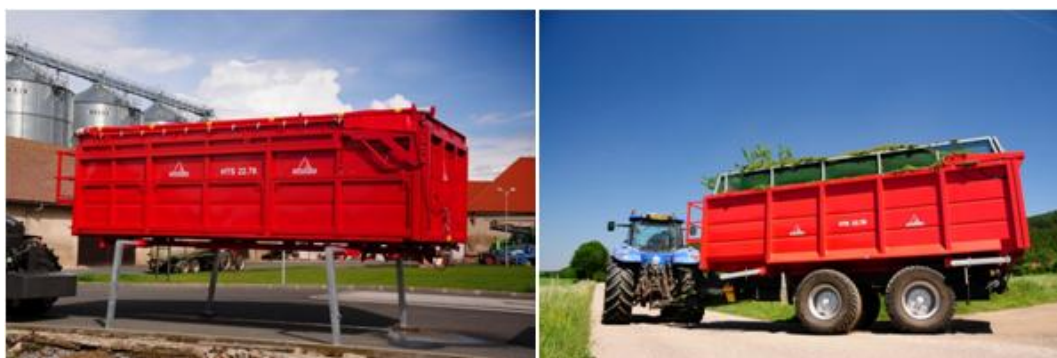
Obr. 18 - Vanová nástavba a vanová nástavba na traktorovém nosiči nástaveb [18]
