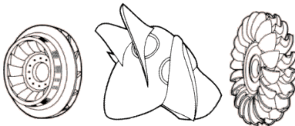
Obrázek 5: Francisova turbína, Kaplanova turbína, Peltonovo kolo [15]
