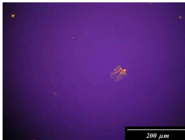
Obr. 26 – Mikrofotografie vrstvy PPV+U10 při ozáření polarizovaným světlem.
