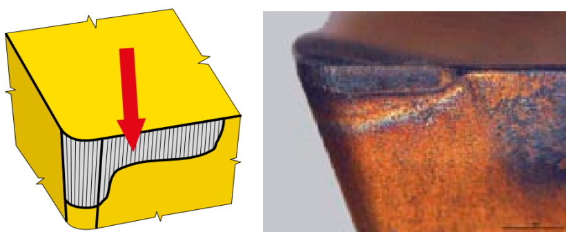
Obr. 8 Opotřebení hřbetu způsobené abrazivním otěrem [19]
