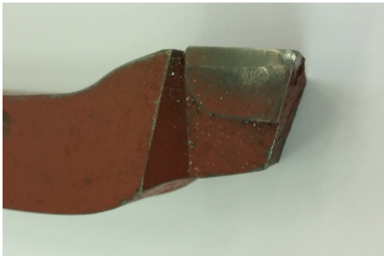
Obr. 33 Ostří nástroje po dosažení hranice trvanlivosti, zdroj: autor
