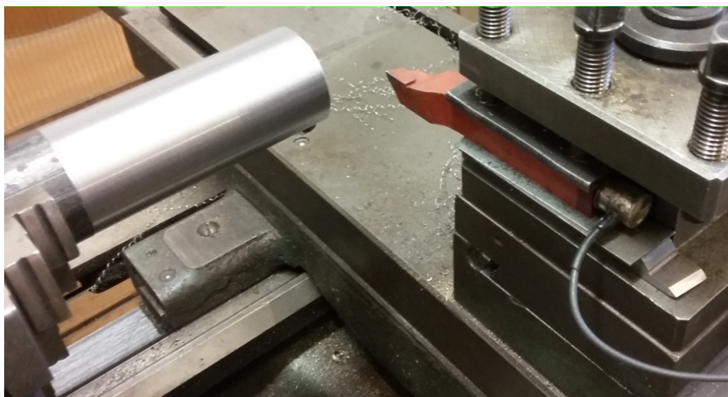
Obr. 24 Umístění snímače akustické emise na noži, zdroj: autor
