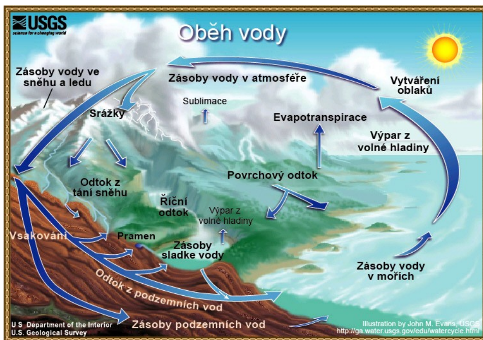
Obr. 1 :Schéma oběhu vody (John Evans and Howard Perlman (USGS), Překlad: Ing. Petr Sercl)
