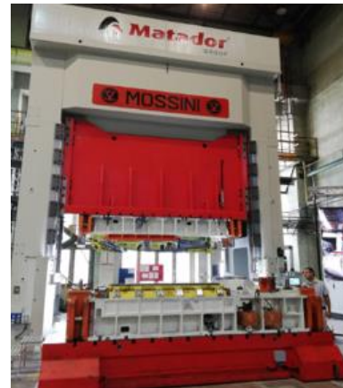
Obr. 22 Hydraulický lis Mossini [32].
