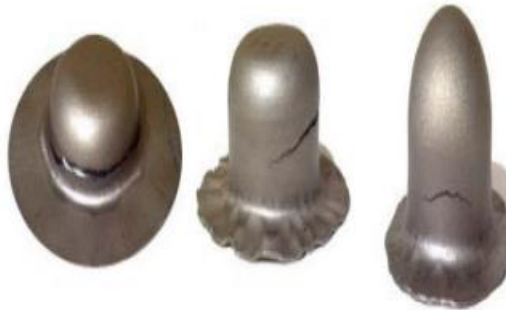
Obr. 18 Zvlnenie a pretrhnutie steny [27].
