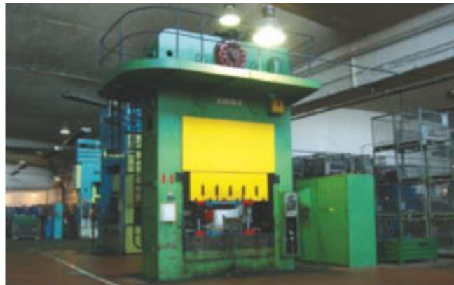
Obr. 20 Mechanický lis 500 PKZZ 2500 [30].
