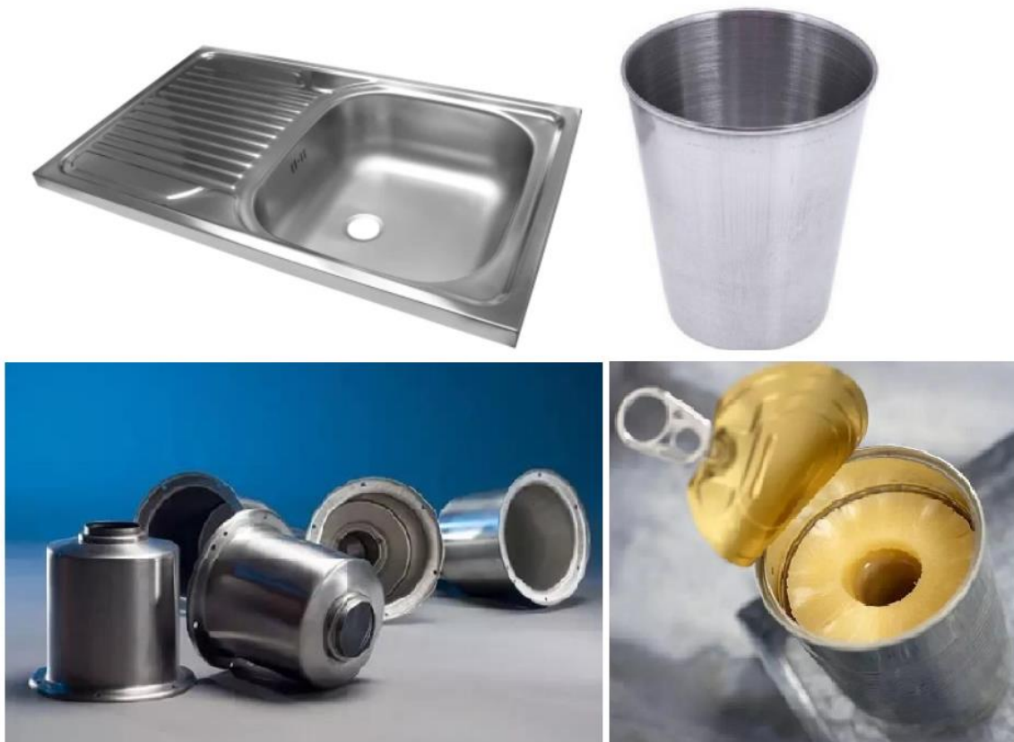
Obr. 1 Príklady výrobkov zhotovených hlbokým ťahaním [5; 6; 7].
