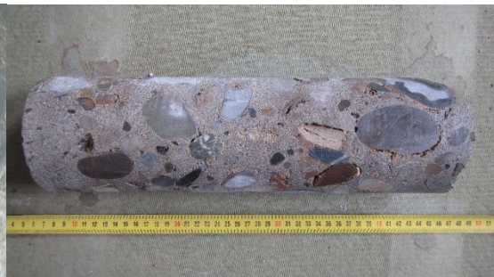
Obr. 40 – Laboratorní foto odebraného vzorku betonu ze sondy V4 [12]
