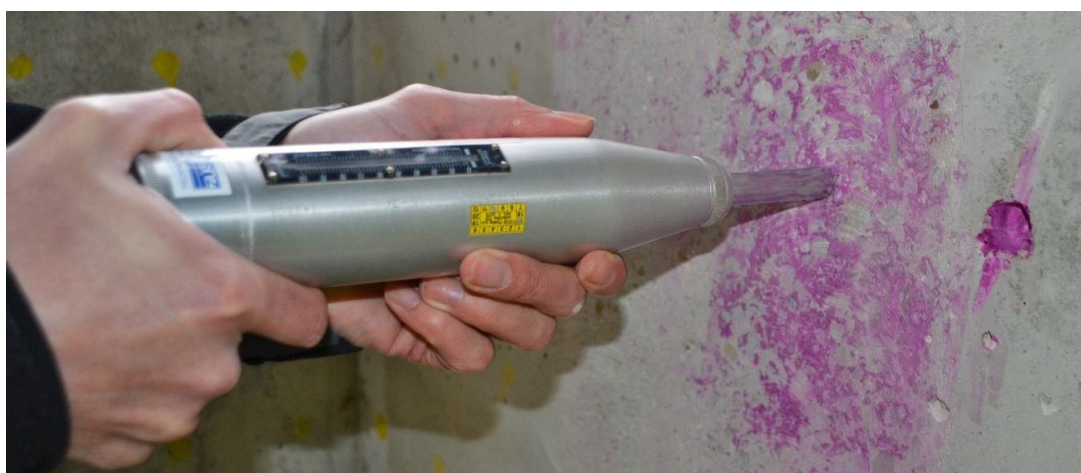
Obr. 9 - Příklad přístroje Schmidt N [8]
