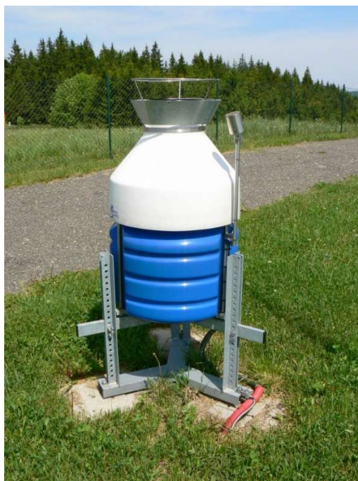
Obr. 6 Automatický váhový srážkoměr. [7]
