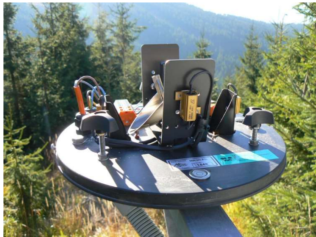
Obr. 5 Impulsní srážkoměr (elektronika a měřicí část). [7]
