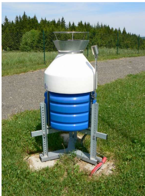
Obr. 6 Automatický váhový srážkoměr. [7]
