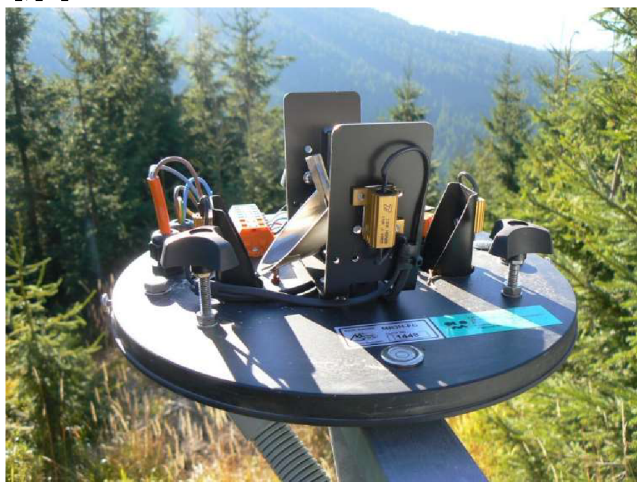
Obr. 5 Impulsní srážkoměr (elektronika a měřicí část). [7]
