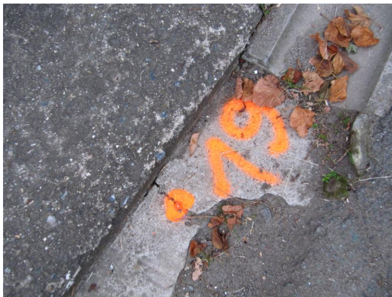
Obr. 7-1 Stabilizace bodu č. 5019 Zdroj: vlastní fotografie
