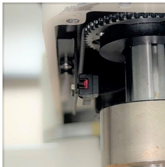
(b) Senzor GL-8F na třetí ose
