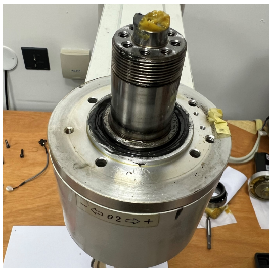
(a) Po demontáži pojistné matice a ložisek zbývá jen demontovat krycí část převodovky
