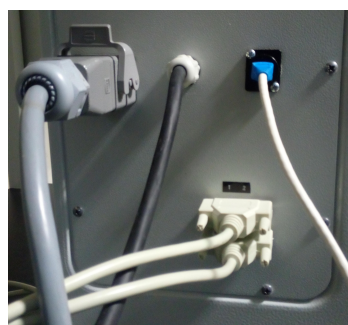
Obr. 4.6: Pohled na konektory na control boxu - Vlevo nahoře konektor Harting následně vpravo průchodka s napájecím kabelem a zásuvka pro datové připojení RJ45, dole se nachází dva 25pinové konektory DB-25 [29]
