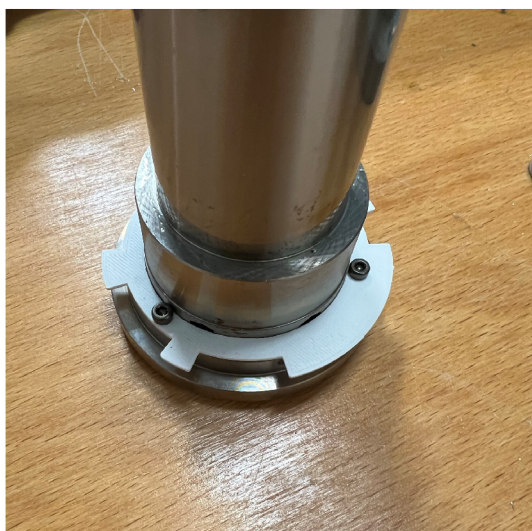
(a) Prototypové plastové enkodérové kolečko
