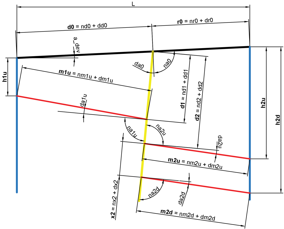
Obrázek 4.9: Schematický náčrt s popisy jednotlivých parametrů modelu koncepte Z – modře jsou vyznačeny měřené plochy, žlutě výsvunná osa Y a červeně výsledné měřené vzdálenosti. Pozn.: Tučné písmo značí vektor, předpona n jmenovitý rozměr a d naopak odchylku od jmenovitého rozměru.
