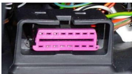
Obr. č. 1 16 pinový OBD II konektor vozidla Škoda Octavia
