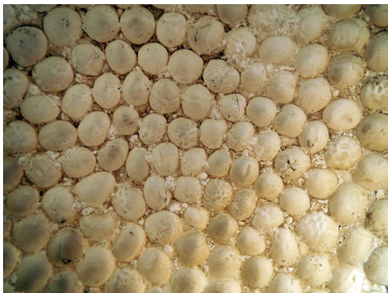
Obr. 19: Vnitřní struktura sádrové formy
