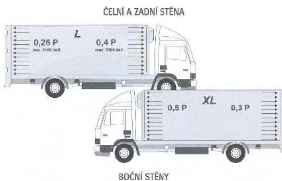
Obrázek 21 Zatížení nástavby dle normy EN 12642
