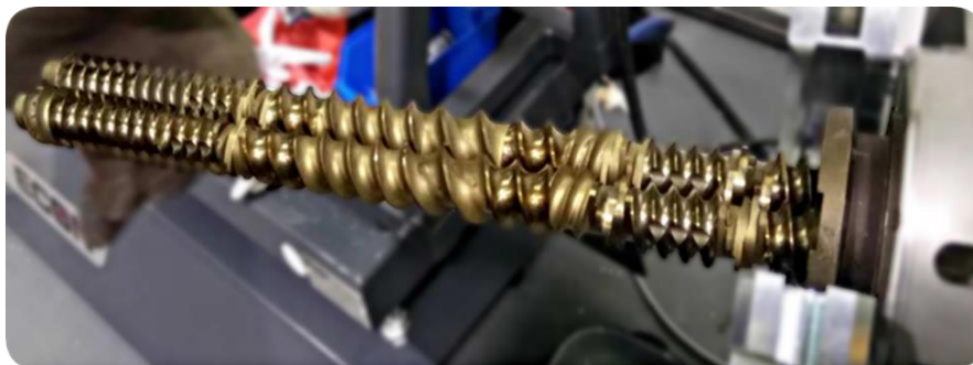
Obr. 3.5 Konfigurace segmentových šneků [44]
