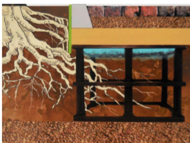
Obr. XVII. Prokořenitelné zemní buňky TreeParker (zdroj: bluegreen.com )
