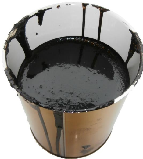
Obr. 25 Použitý asfalt modifikovaný pryžovým granulátem
