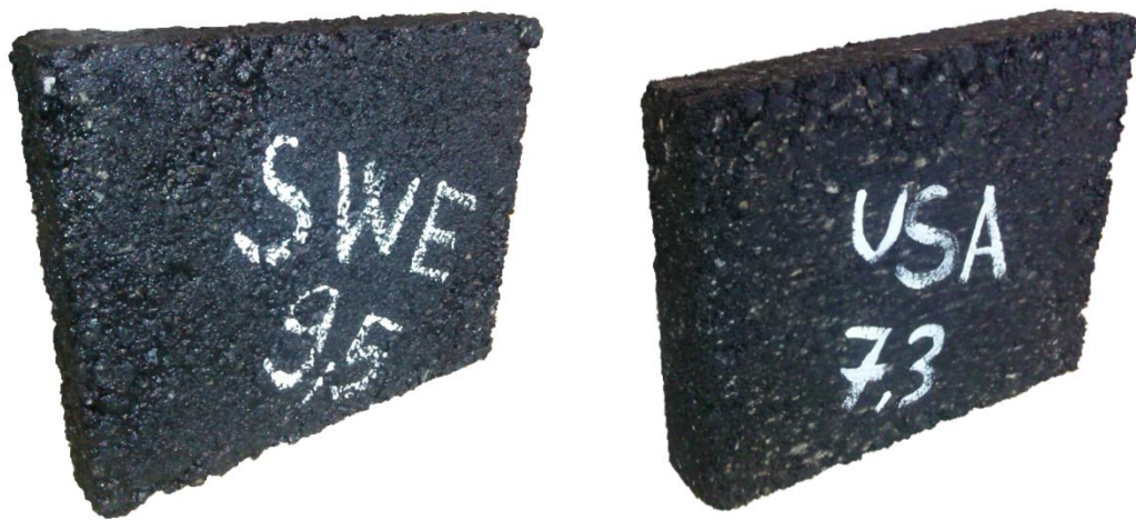
Obr. 28 Vyrobené desky obou směsí segmenotvým zhutňovačem
