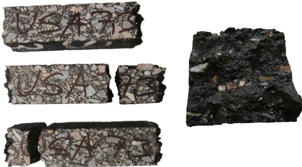
Obr. 31 Porušené vzorky směsi AC 16 při zjišťování nízkoteplotních vlastností
