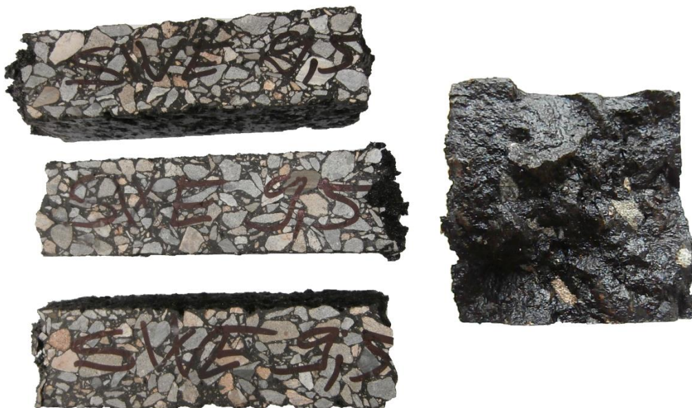
Obr. 29 Porušené vzorky směsi SMA 16 při zjišťování nízkoteplotních vlastností
