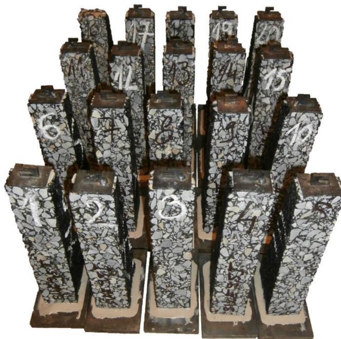
Obr. 33 Zkušební komolé klíny pro zjištění modulu tuhosti a odolnosti proti únavě
