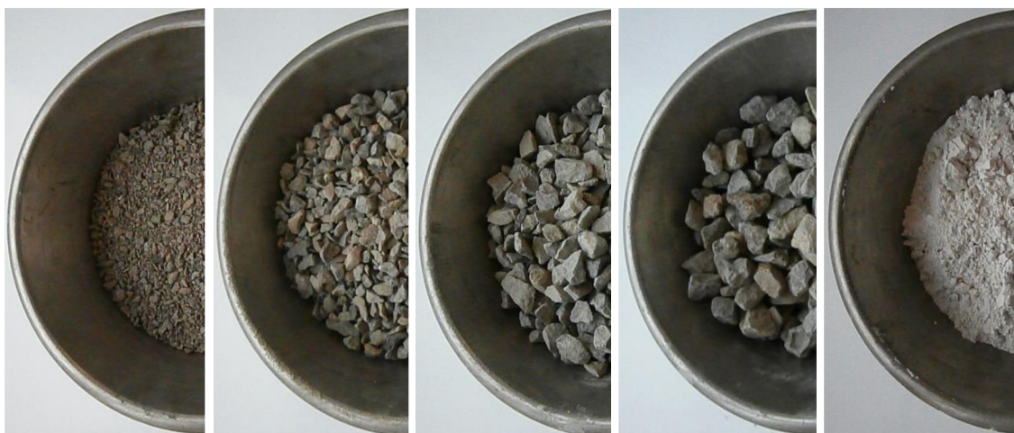
Obr. 24 Jednotlivé frakce použitého kameniva a fileru
