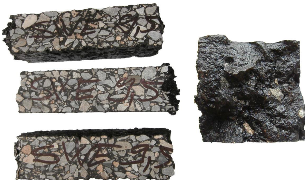
Obr. 29 Porušené vzorky směsi SMA 16 při zjišťování nízkoteplotních vlastností
