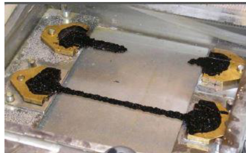
Obr. 15 Natahovaný a přestřížený vzorek [6]
