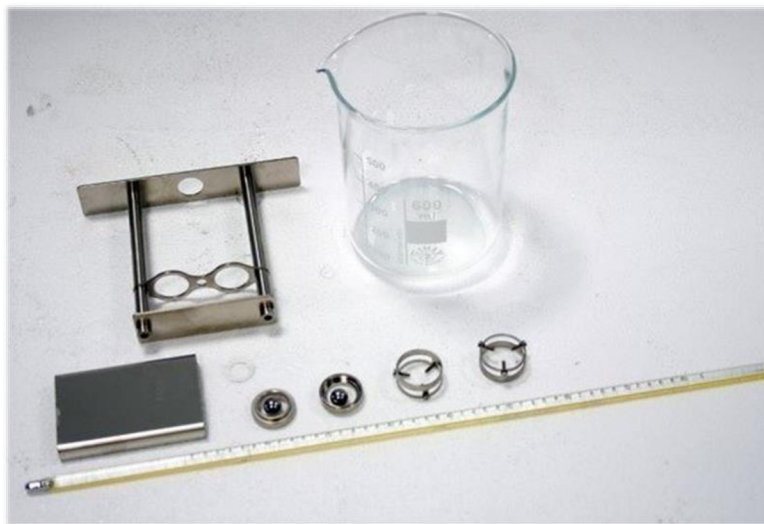
Obr. 11 Souprava pro stanovení bodu měknutí [34]
