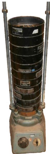
Obr. 9 Elektro mechanická prosévačka kameniva
