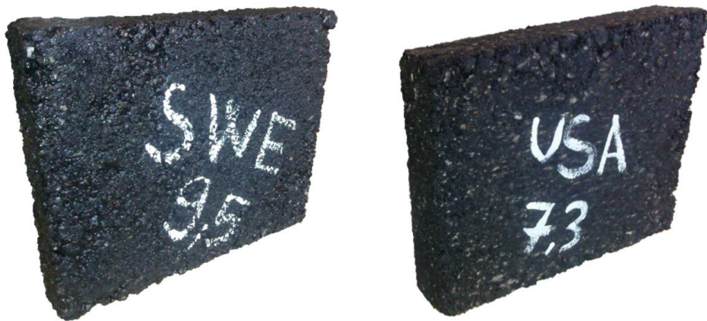
Obr. 28 Vyrobené desky obou směsí segmenotvým zhutňovačem
