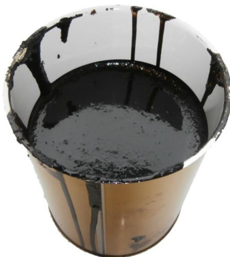
Obr. 25 Použitý asfalt modifikovaný pryžovým granulátem
