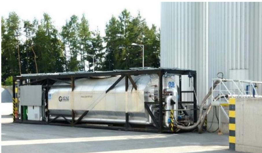
Obr. 2 Mísicí zařízení (blender) pro výrobu CRmB [3]
