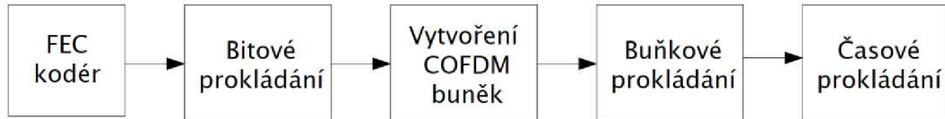
Obr. 3 Blokové schéma „Bitového prokládání, kódování a modulace“ (BICM)
