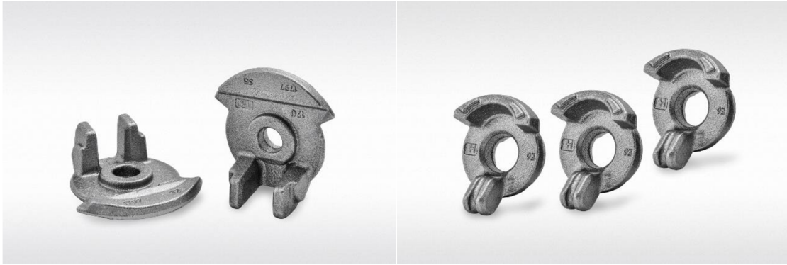
Obrázek 4: Odlitky Thrust Flange a Drive Hub
