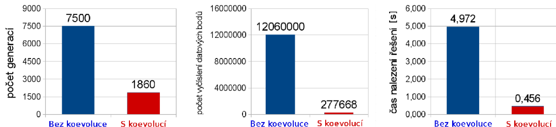
Obrázek 7.2: Porovnání řešení bez koevoluce a s koevolucí funkce f(x) = e^{|x|} \sin(x) pro medián z 50 běhů.
