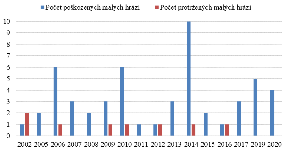
Obr. 4.20 Počet poruch a protržení hrází v důsledku vnitřní eroze od roku 2002 do roku 2020 (v předešlých letech nebyly registrovány poruchy či protržení v důsledku vnitřní eroze)
