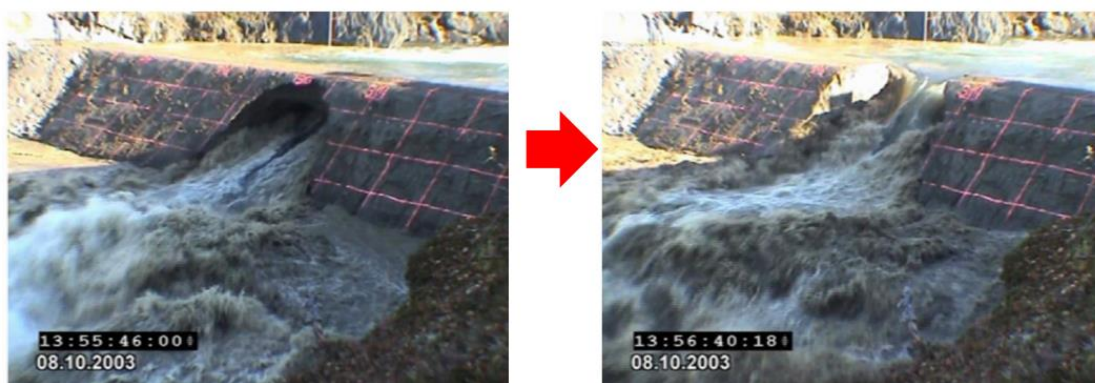
Obr. 7.6 Zřícení nadloží průsakové trubice (Vaskinn a kol., 2004)
