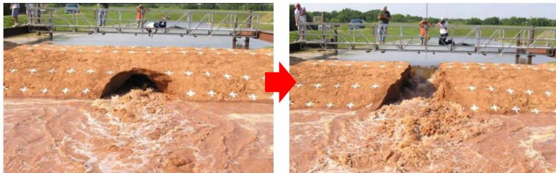
Obr. 7.7 Zřícení nadloží průsakové trubice (Hanson a kol., 2010)
