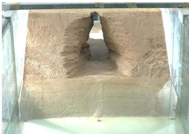
Obr. 7.8 Pohled na průlomový otvor a nadloží průsakové trubice (Okan, 2022)
