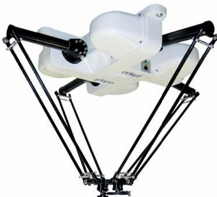
Obr. 4.3: Robot Adept Quattro s650 od společnosti Adept [13].
