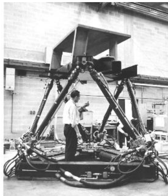
Obr. 1.6: První letecký simulátor založený na využití oktahedrálního hexapodu [2]
