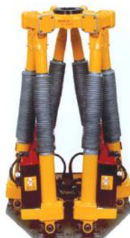
Obr. 2.5: Plně paralelní mechanismus HEXALIGHT 6D M-840 [9].
