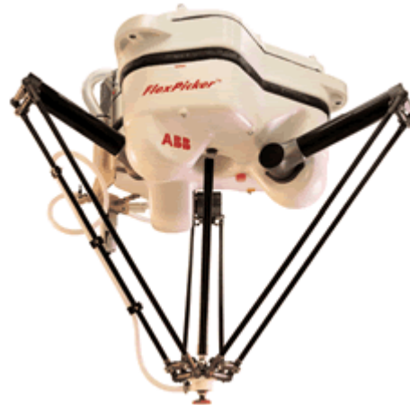
Obr. 2.4: Manipulátor s PKS typ IRB 340 FlexPicker (ABB) [8].
