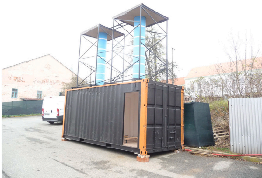
Obr. 3.1 Testovací kontejner s podpůrnou konstrukcí se světlovedy, Ostrovačice
