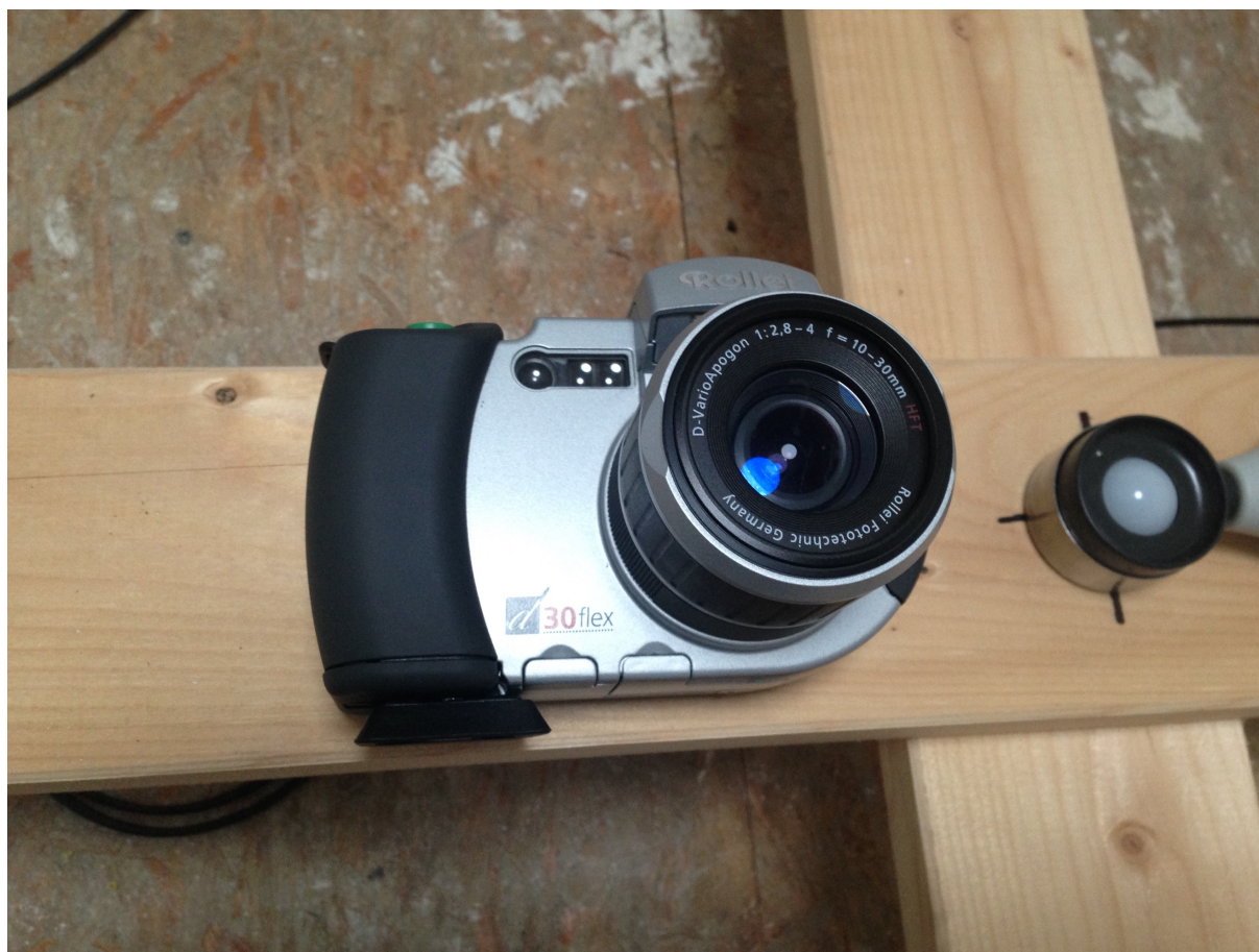
Obr. 3.12 Fotografie kamery Rollei d30 flex umístěné vedle čidla luxmetru v ose pod světlovodem
