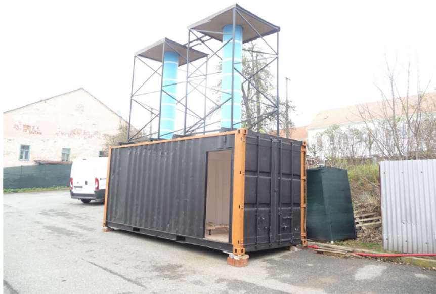
Obr. 3.1 Testovací kontejner s podpůrnou konstrukcí se světlovody, Ostrovačice
