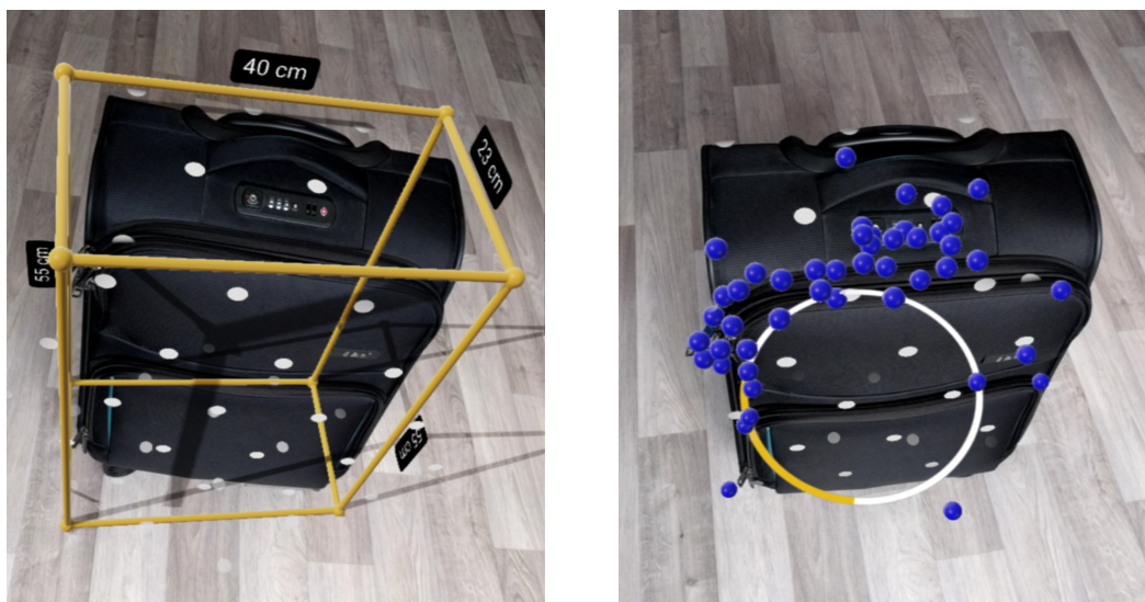
Obrázek 3.10: Navržené vizualizace virtuálních objektů rozšířené reality. Vlevo je navržený měřicí box s popisky hran. Vpravo je vizualizace nasbíraných bodů. Kruh pro výběr objektu v tomto případě slouží k vizualizaci průběhu měření.
