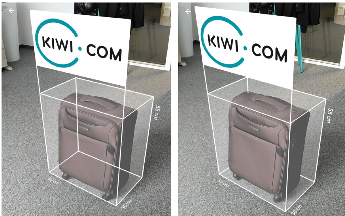
Obrázek 2.12: Příklad využití dat z hloubkoměru pro řešení viditelnosti čar virtuálního kvádrů. Vlevo je řešení viditelnosti vypnuto a vpravo zapnuto. (Zdroj: aplikace Kiwi.com)
