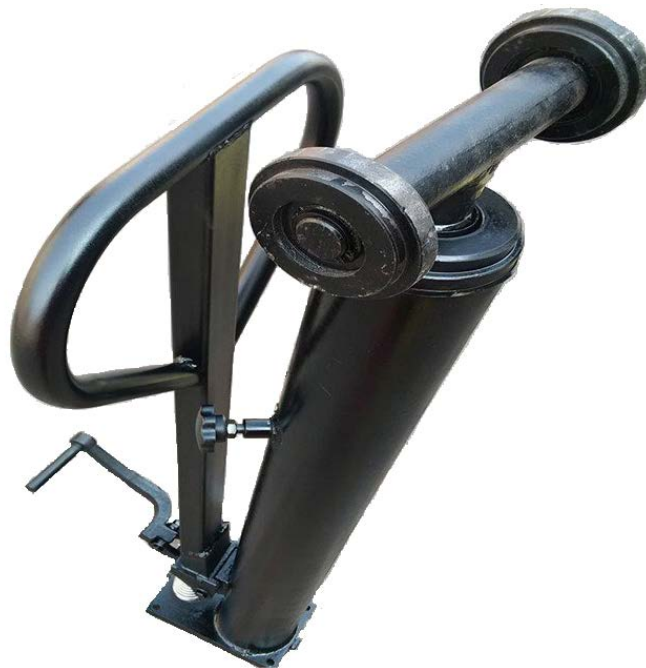
Obrázok 22 Lineárny hydromotor s ručným pohonom zdvihu [18].
