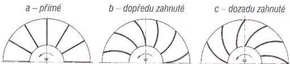
Obr.20 Tvary lopatek oběžných kol radiálních kompresorů [20]
