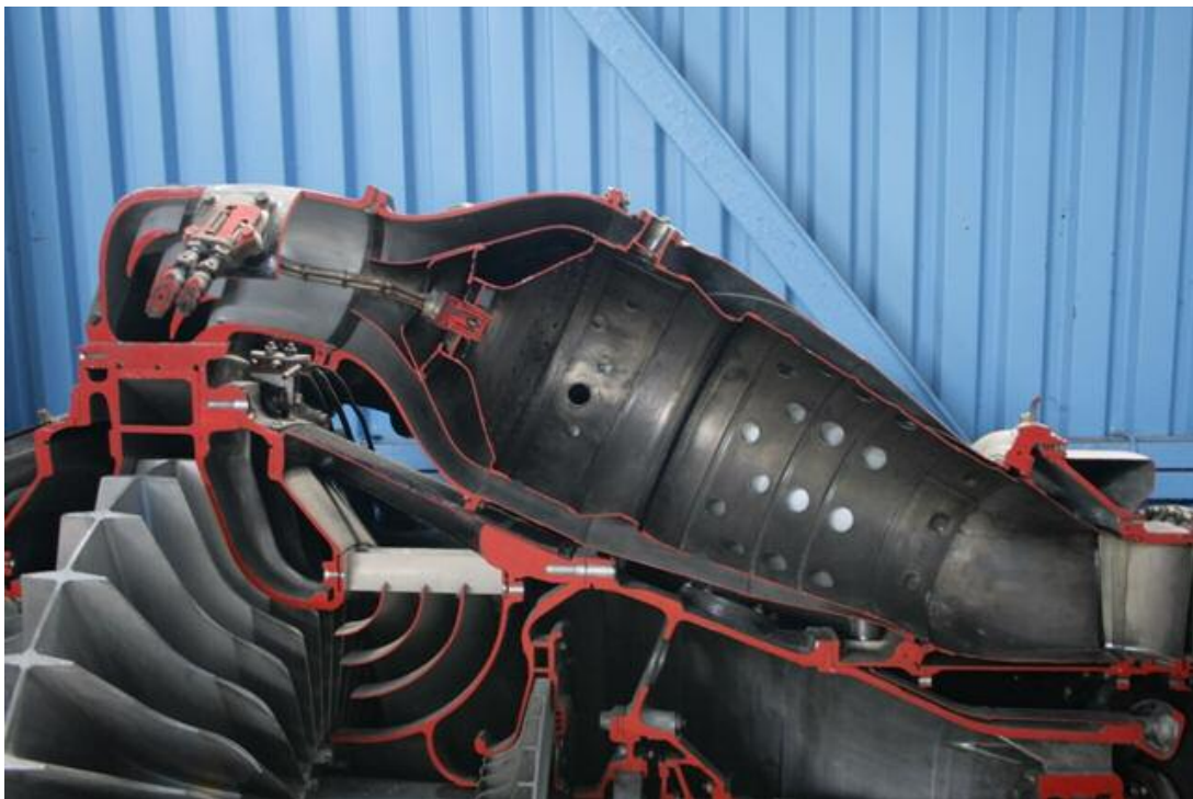
Obr.24 Detail spalovací komory v řezu [26]
