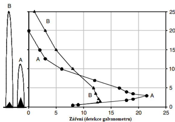
Obr. 5 Vliv předehřevu na délce plamene [6]
