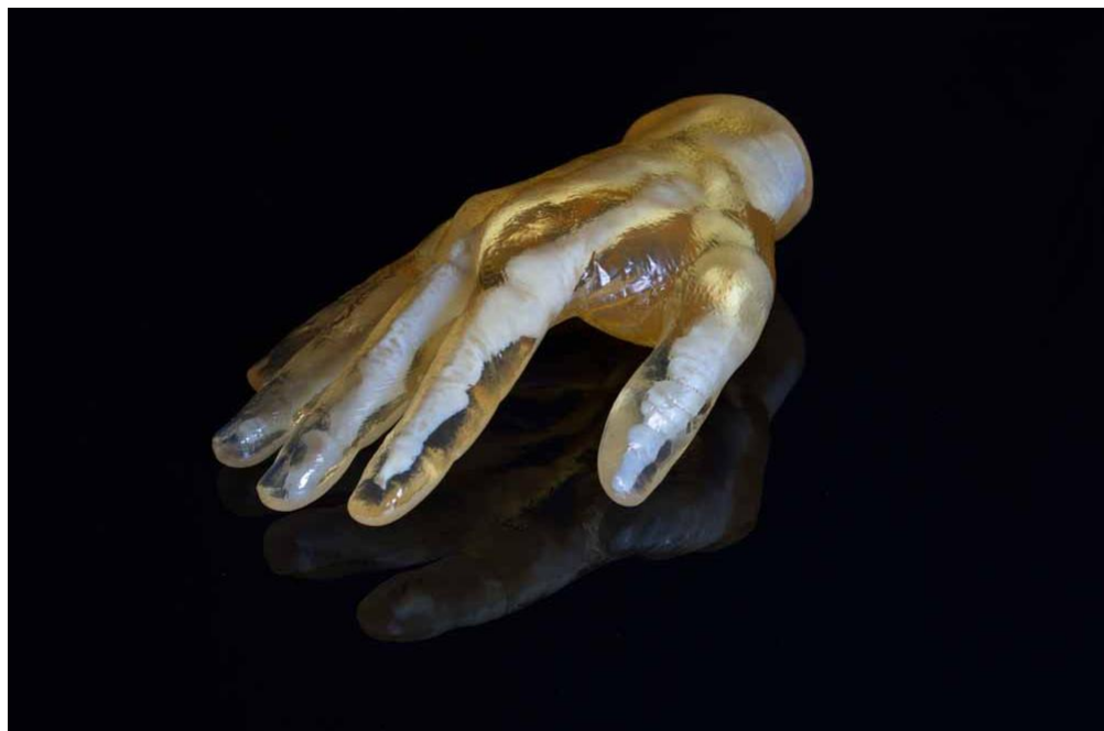
obr. 7 Ruka s kostí vyrobená technologií Polyjet Matrix [10]
