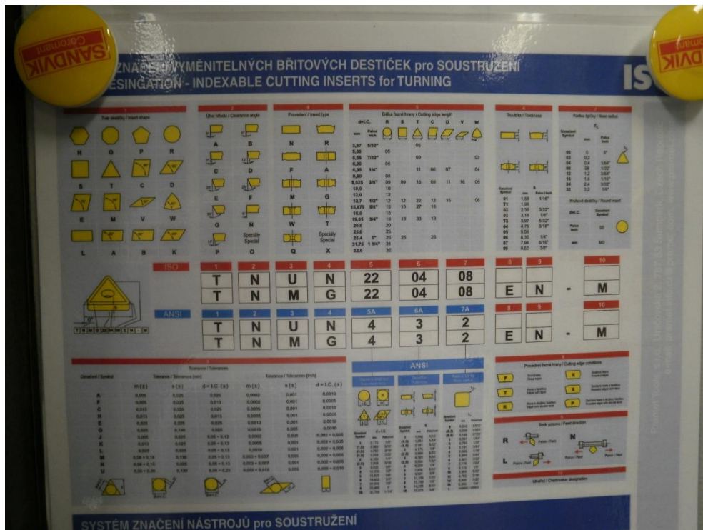
Příloha A 3: Označení s hodnotami pro karbidové destičky.
