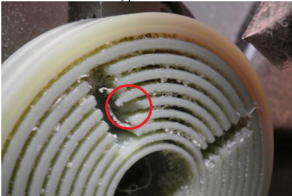
Příloha A 6: Při vyjetí nože z žeber do drážky, docházelo k vylamování. Obrobek se točí po směru hodinových ručiček.
