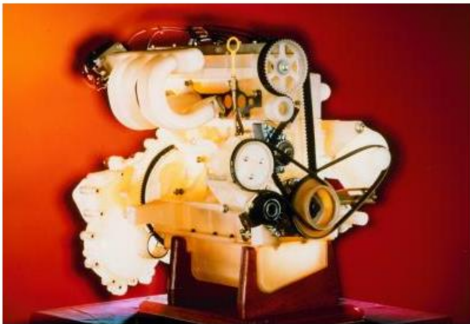
Obr. 3 Sestava motoru vyrobená technologií RP [1]
