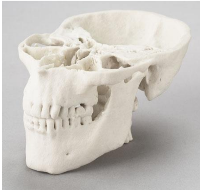
Obr. 4 Náhradní čelist vyrobená 3D tiskem [5]
