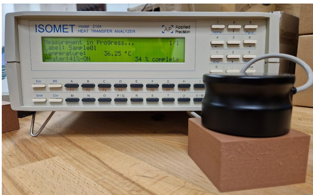
Obrázek 16 Měření tepelné vodivosti přístrojem ISOMET 2104
