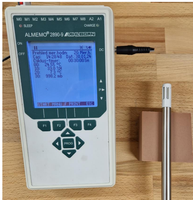
Obrázek 17 Měření teploty a relativní vlhkosti vzduchu přístrojem ALMEMO 2890-9 se sondou FHAD 46-41
