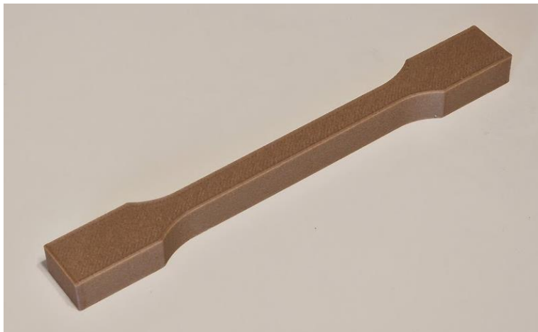
Obrázek 14 Vytištěný vzorek pro měření tahových vlastností
