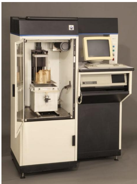
Obrázek 1 SLA-1, první komerční stereolitografická 3D tiskárna (Kazilbash, 2021)
