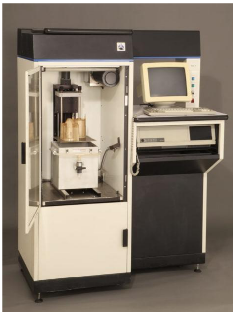
Obrázek 1 SLA-1, první komerční stereolitografická 3D tiskárna (Kazilbash, 2021)
