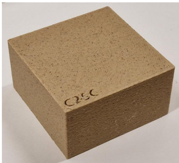
Obrázek 7 Vytištěný vzorek pro měření tepelné vodivosti a tlakových vlastností
