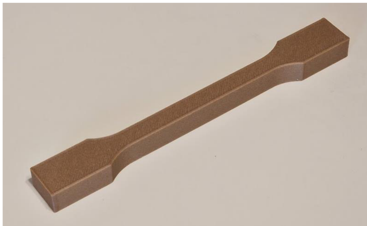
Obrázek 14 Vytištěný vzorek pro měření tahových vlastností
