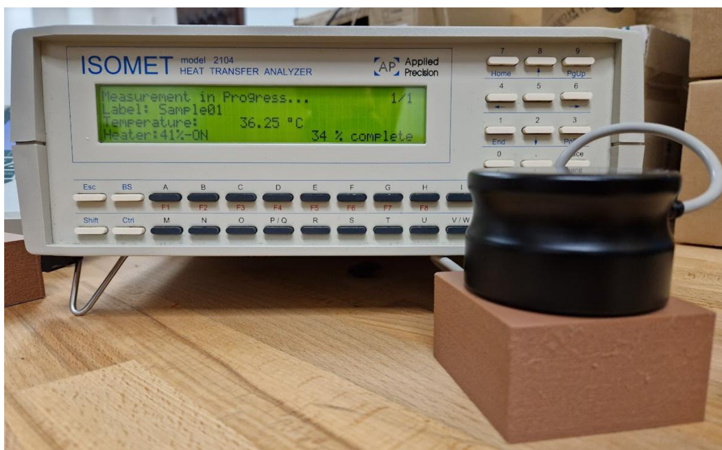
Obrázek 16 Měření tepelné vodivosti přístrojem ISOMET 2104
