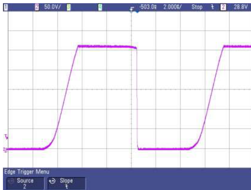
Obr. 60: Průběh napětí u_{CE} dolního tranzistoru při chodu naprázdno při napětí polovičního meziobvodu 250 V
