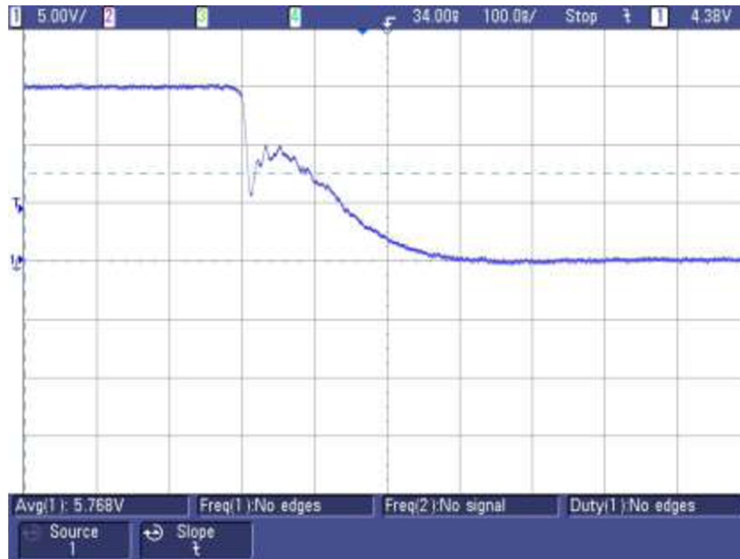
Obr. 57: Detail procesu vypnutí z průběhu signálu na Obr. 55
