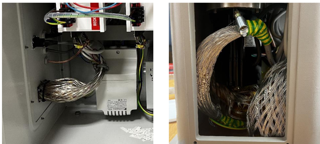
Obrázek 5.6 Použití opletu v rozvaděči a těle manipulátoru
