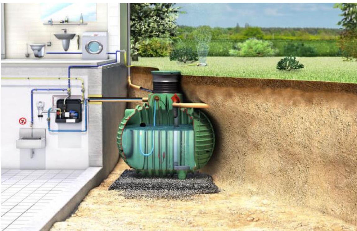
Obrázek 17: Nádrž COLUMBUS 4500 L, v řezu po zapojení
