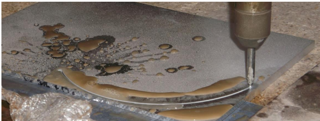
Obr. 17 Řezání podstavce hydroabrazivním paprskem.
