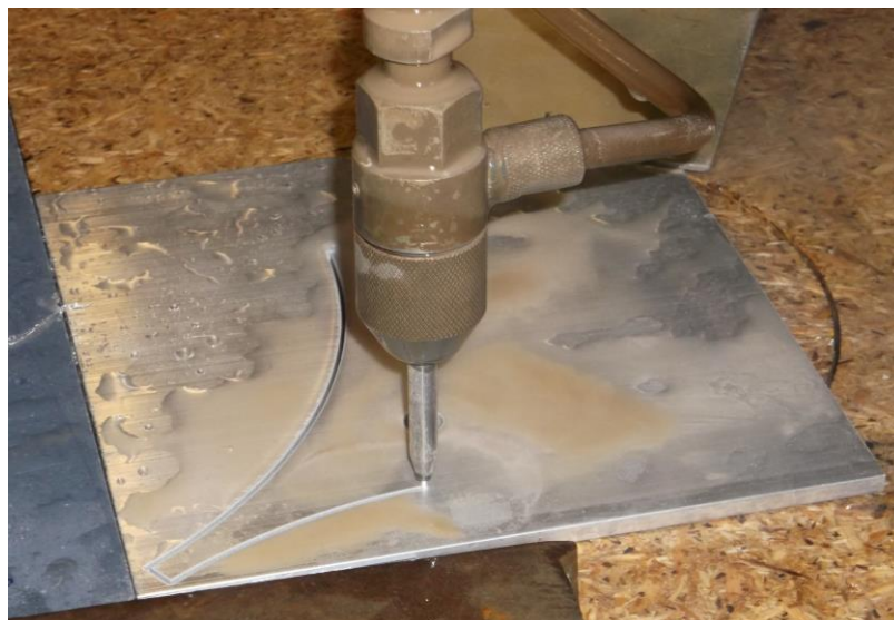
Obr. 18 Řezání základového tělesa hydroabrazivním paprskem.
