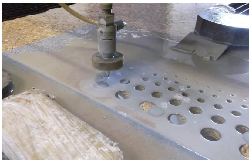
Obr. 24 Řezání stínítka hydroabrazivním paprskem.
