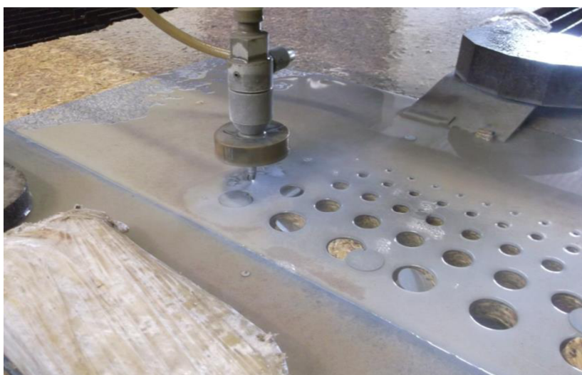
Obr. 24 Řezání stínítka hydroabrazivním paprskem.
