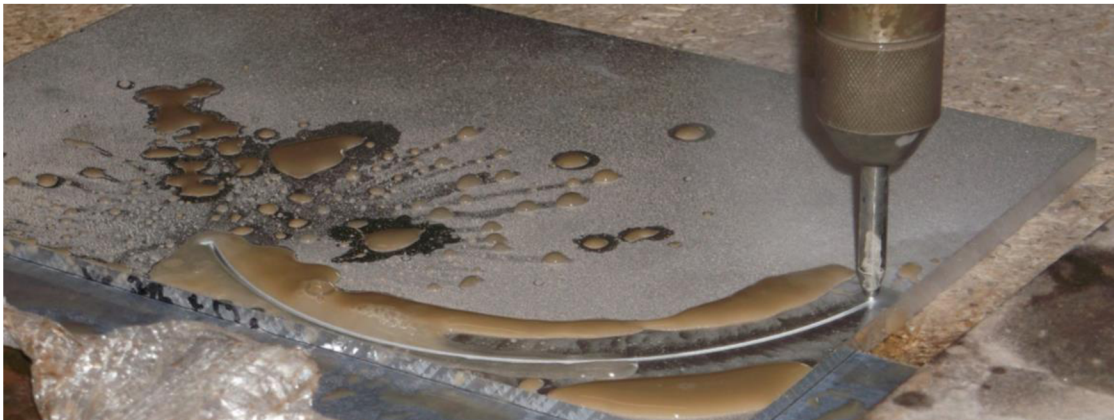
Obr. 17 Řezání podstavce hydroabrazivním paprskem.
