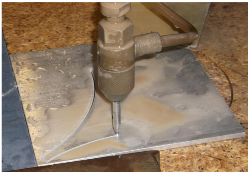
Obr. 18 Řezání základového tělesa hydroabrazivním paprskem.
