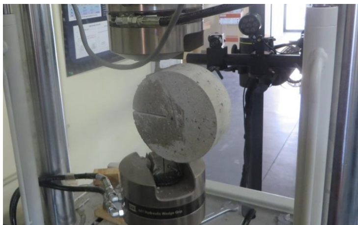
Obr. 16. Zkušební těleso pro únavovou zkoušku uchycené v testovacím lisu
