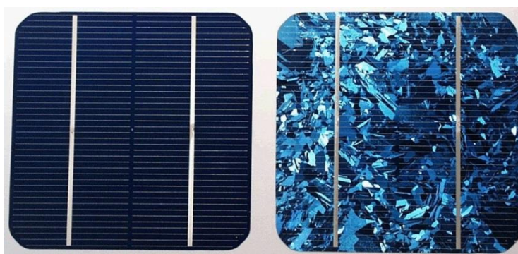
Obrázek č. 3: Monokrystalický (vlevo) a polykrystalický článek [9]
