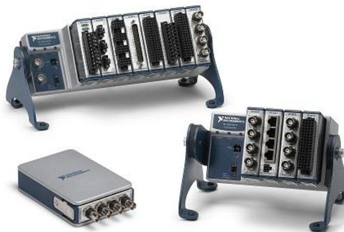
Obr. 13 Různá provedení systému CompactDAQ s měřicími kartami.[24]
